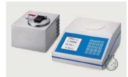
Ausgestattet mit einem großen LCD-Display, einer spritzwassergeschützten Folientastatur und einer umfangreichen Gerätesoftware sind diese Refraktometer durch ihren großen Arbeitstemperaturbereich neben den Standardanwendungen auch für spezielle Messaufgaben in Forschung und Industrie geeignet.
